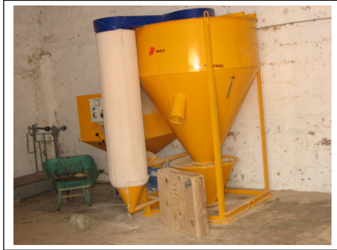
Broyeur – mélangeur de la ferme de Nianing.
